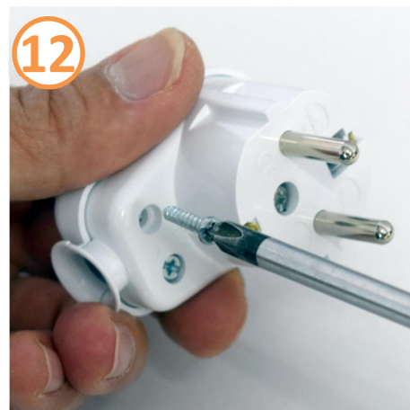
Викрутіть центральний гвинт та один з гвинтів фіксатора повністю, а другий - на половину.
